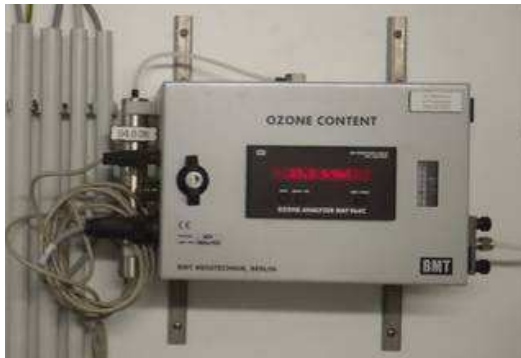
Abbildung 21: BMT-Sonde: Messung der Ozonkonzentration im Gas
