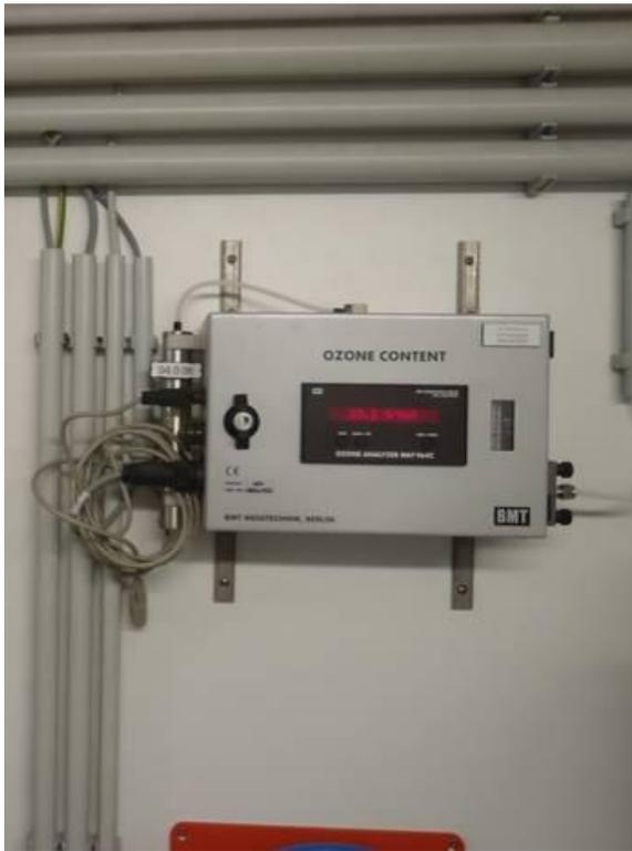
Abbildung 17: BMT-Sonde: Messung des Ozongehalts im Gas
